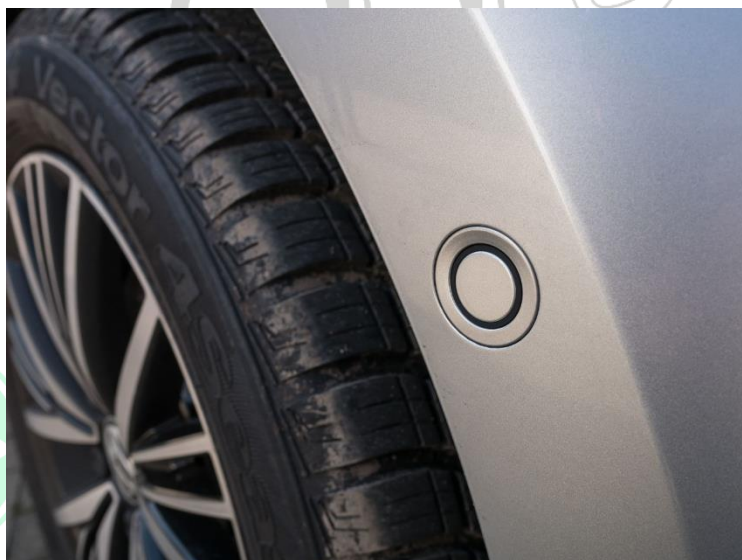
Czujnik ultradźwiękowy (Zdjęcie: Wikipedia, Basotxerri, CC BY-SA 4.0)
